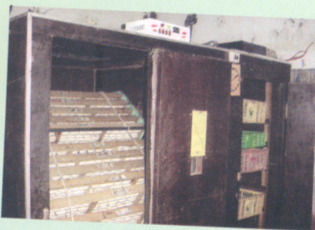
Tủ ấp NĐT 5 - 8.000 quả (Tủ thủ công cải tiến) Sản xuất tại Trung tâm nghiên cứu vịt Đại Xuyên
