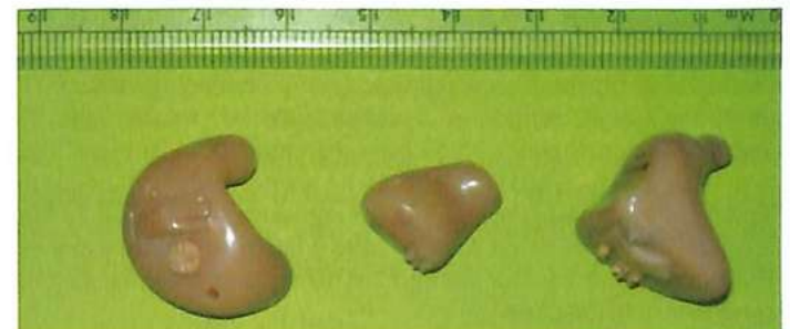
Hình 4.12 Máy trợ thính đặt trong tai (in-the-ear) và trong ống tai (in-the-canal) [hình ở giữa].
