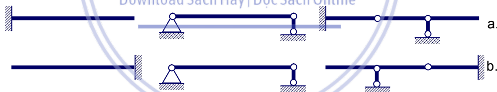
Hình 7.14. Sơ đồ dầm giả tạo (b.) ứng với dầm thực (a.)
