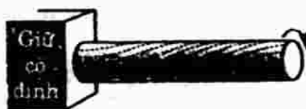
d) Đoạn dây đồng bị xoắn
