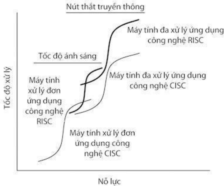
Hình 6.6. Các gián đoạn công nghệ từ CISC tới RISC trong tính toán xử lý đơn và đa xử lý.
